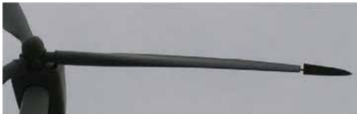
Şekil 4. Kanatta merkezkaç kuvvetiyle uzayan uç kısmı (Killa ve Smith, 2008)
