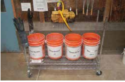
Görsel 1. Oregon Üniversitesi'ndeki bu dört kovalı sistem, daha sonra geri dönüştürülmüş kil ile birlikte kaldırım tuğlaları yapmak için kullanılan tüm sıratıkların toplamak için yapılan tasarım.
